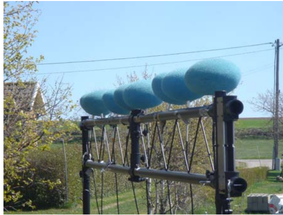
Figur 3: Mikrofonantenn med 8 mikrofoner på Öland (Hammarby) för att fånga upp och förstärka ljud i riktning från Utgrundens fyr.
