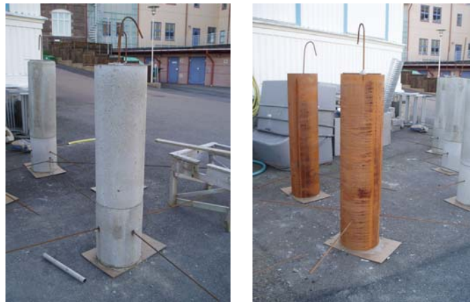
Fig. 6. Vindkraftfundament tillverkas i olika material. För att studera hur olika material påverkar påväxt och fisk genomförs ett experiment i fält där konstgjorda vindkraftfundament tillverkade av betong respektive stål placeras i havet. Foto: M. Andersson.
