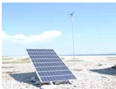
Solceller och vindkraft laddar det meteorologiska mätsystemet på Östergarnsholm utanför Gotland.
