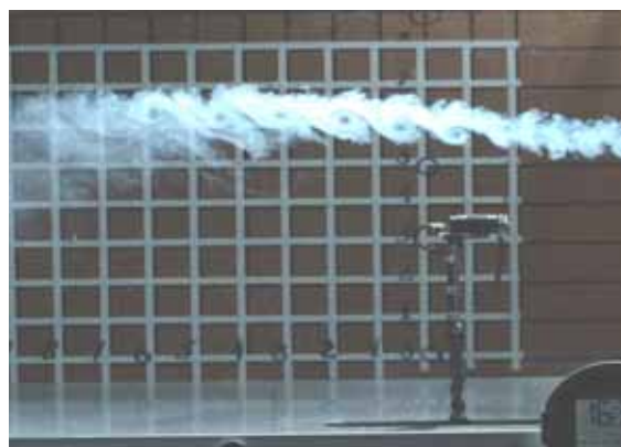
Typisk situation i FFAs tunnel med beteckningen LT5. Vad som avslöjas av rökbilden är den övre delen av de virvelspiraler som avsöndras från bladens spetsar.
